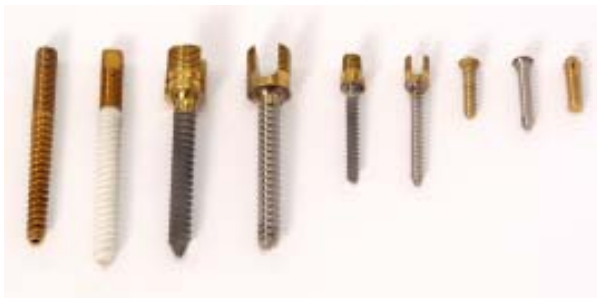
Рисунок 3. Винты транспедикулярные с различным покрытием TiN, Al 2 O 3
