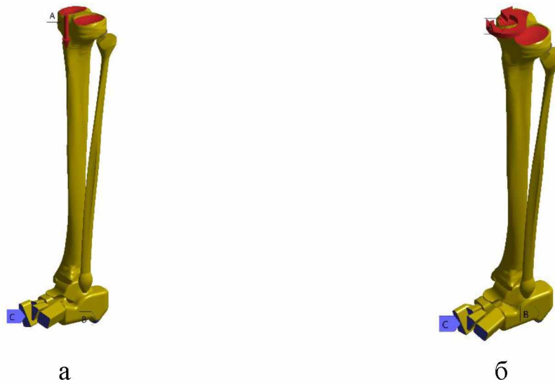
Рисунок 2.11 – Схеми навантаження моделей: а – вертикальне осьове стискання; б – кручення.
