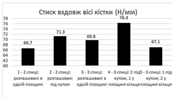
Рис. 2. Порівняння жорсткості системи на стиск при різних схемах компоновки
