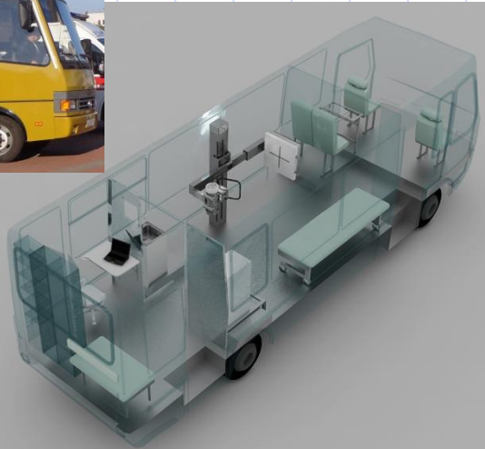
Передвижной кабинет цифровой рентгенографии
