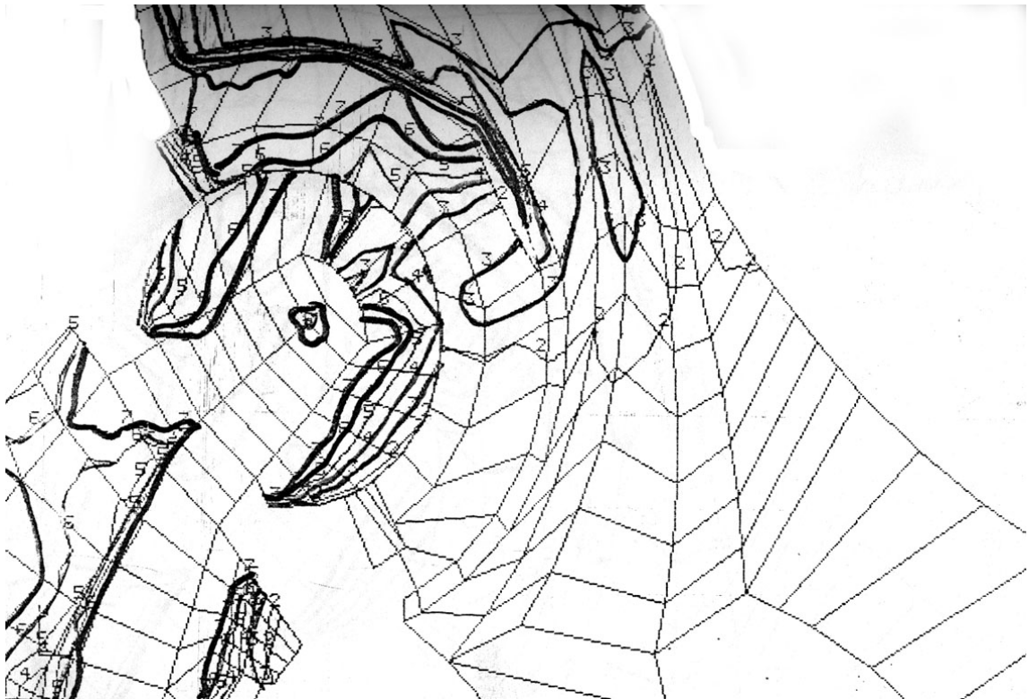
Рис.3.7 Напряжения в тазовой кости при установке чашки эндопротеза под углом 55^{\circ} к горизонтали
