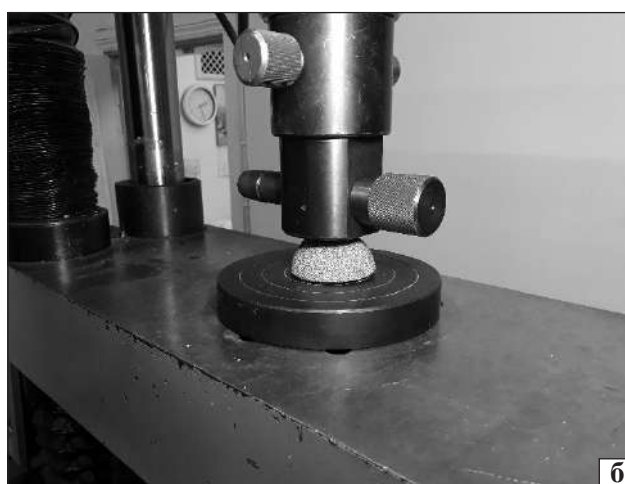
Рис. 4. Випробування чашок ендопротезів на стискання: схема (а) та зразок на стенді під час експерименту (б)
