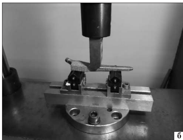
Рис. 2. Випробування ніжок ендопротезів на триточковий згин: а) схема випробувань; б) зразок на стенді під час експерименту
